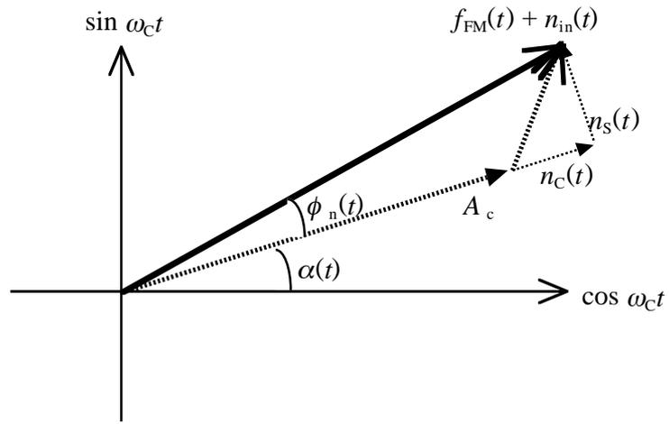
図 1 0 雑音が加わったFM信号のベクトル表示 (LPF出力)
