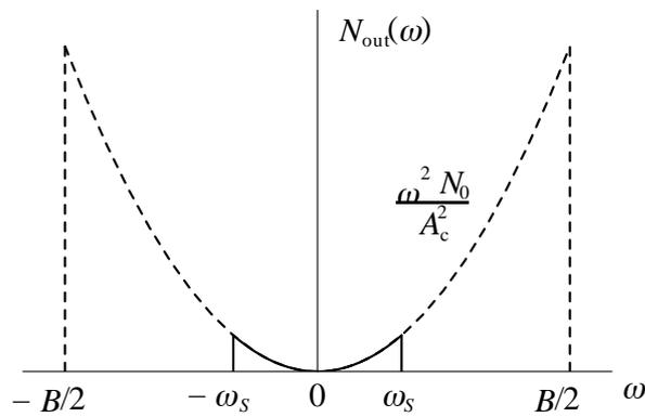
図 1 2 LPF出力雑音のベースバンド電力密度スペクトル
