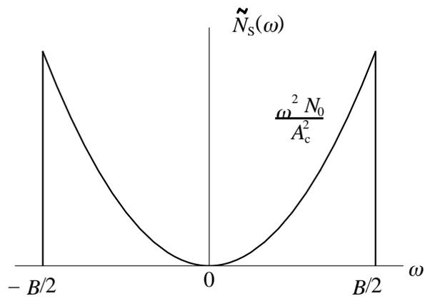
図 1 1 微分器出力雑音のベースバンド電力密度スペクトル
