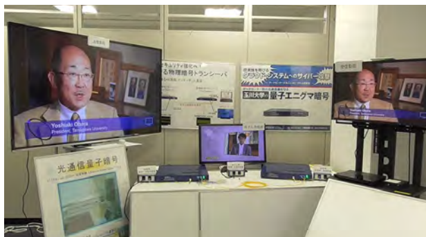
左画面の映像が暗号化され光ファイバ回線を通して通信され右画面にリアルタイムで表示されている
