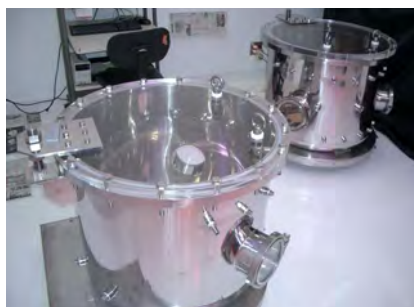
宇宙農場ラボの 減圧植物栽培チャンバー
