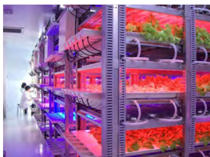
多段式 LED 水耕栽培システム
