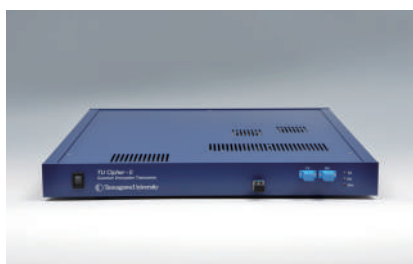
【量子情報科学研究所】量子エンigma暗号トランシーバ (TU Cipher-0)
