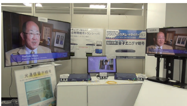
FST 棟 2F 展示室に設置されている Y-00 暗号トランシーバのライブデモの様子。左画面の映像が暗号化されて光ファイバ回線を通り右画面にリアルタイムで表示されている
